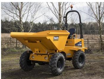
Der 4,5-Tonnen-Kipper von Thwaites wurde unter Berücksichtigung von Auftragnehmern und Mietern hergestellt. Dies gewährleistet die Sicherheit des Bedieners, verringert das Risiko vor Ort und verbessert die Leistung. Angetrieben von einem 34,8 kW Yanmar-Motor mit einem maximalen Drehmoment von 158 Nm für optimale Traktion. Diese Maschine ist in der folgenden Konfiguration erhältlich, um Ihren Anforderungen zu entsprechen:
