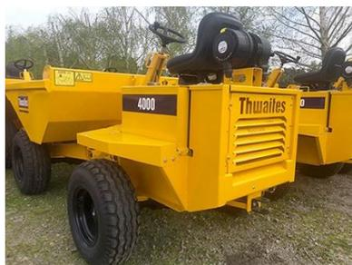
Der Thwaites 4000D ist ein 2-Tonnen-Kipper, der speziell für den Export nach Afrika, in den Nahen Osten sowie in Entwicklungs- und nicht EU-regulierte Länder hergestellt wurde. Angetrieben von einem 20,2 kW Deutz-Motor mit einem maximalen Drehmoment von 86 Nm für optimale Traktion erfüllt diese Maschine die Emissionsvorschriften der Stufe II.
