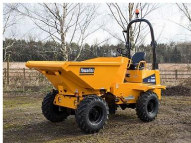
Der 3,5-Tonnen-Kipper von Thwaites wurde unter Berücksichtigung von Auftragnehmern und Mietern hergestellt. Dies gewährleistet die Sicherheit des Bedieners, verringert das Risiko vor Ort und verbessert die Leistung. Angetrieben von einem 33,3 kW Yanmar-Motor mit einem maximalen Drehmoment von 141 Nm für optimale Traktion. Diese Maschine ist in der folgenden Konfiguration erhältlich, um Ihren Anforderungen zu entsprechen:
